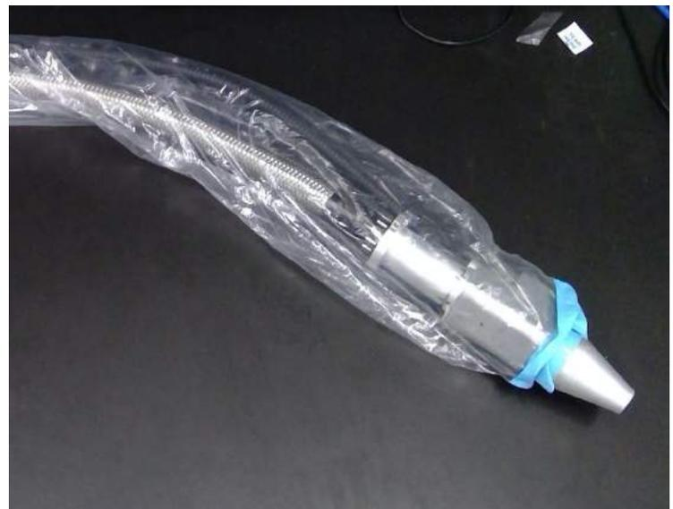
Figure 4 : Drap stérile enveloppant la sonde et les bundles imageants
